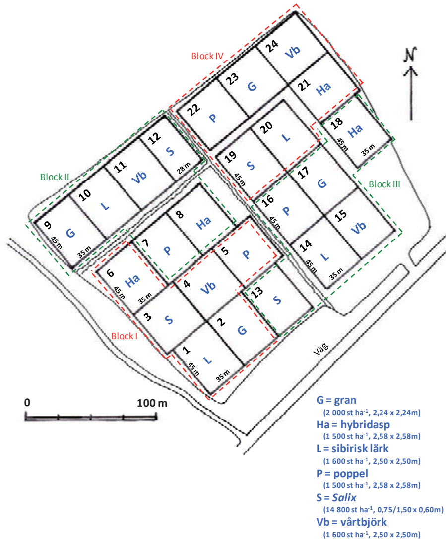
Figur 4. Försöksdesignen på försöket i Norrsvedje. Fyra block innehåller vardera sex ytor med de olika trädslagen. Försöksområdet genomkorsas av ett par diken. G = gran, Ha = hybridasp, L = sibirisk lärk, S = Salix, P = poppel och Vb = värtbjörk.
