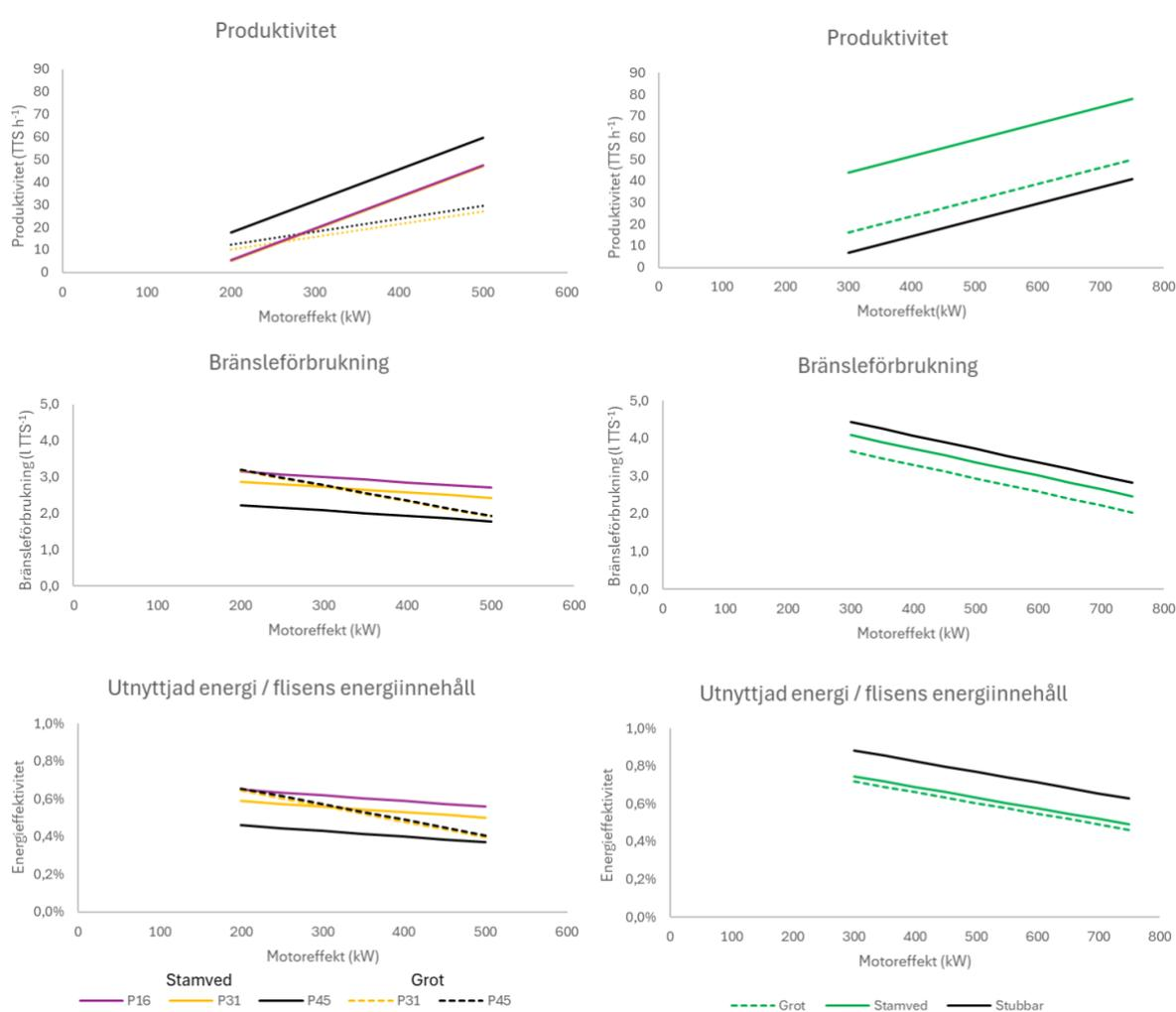
Figur 1. Produktivitet, bränsleförbrukning och energieffektivitet för trumhuggar (vänster kolumn) vid flisning av grot och stamved till olika flisfraktioner, samt för krossar (höger kolumn vid flisning av grot, stamved och stubbar).
