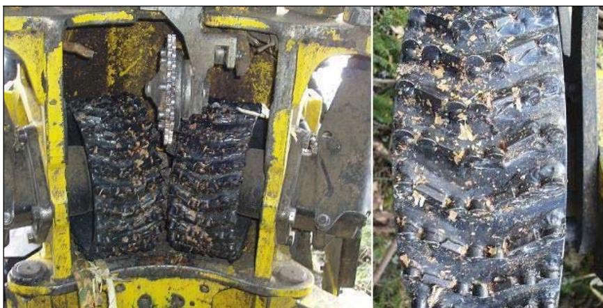
Figur 2. Försöksuppsättning 1, V-profil. Till vänster de inre valsarna och till höger en närbild på de yttre.
