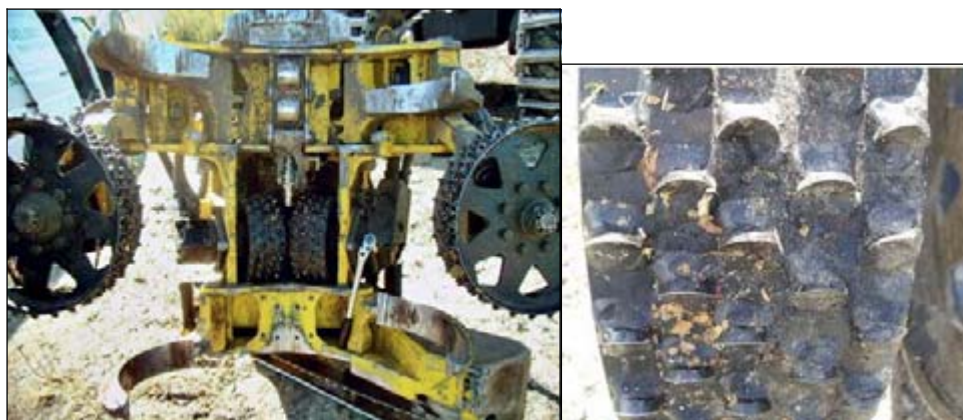
Figur 3. Försöksuppsättning 2, piggvals. Till vänster de inre valsarna och till höger en närbild på de yttre.
