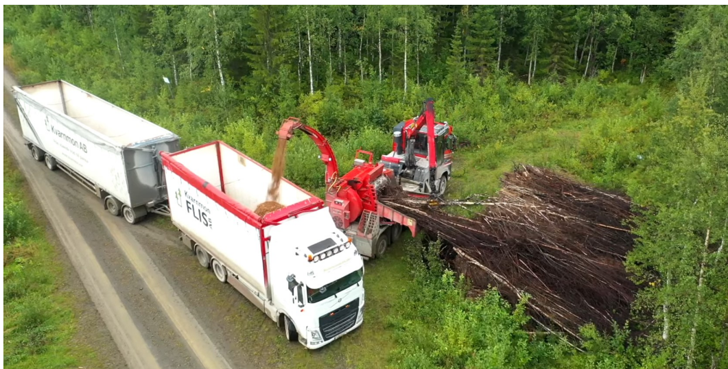
Figur 6. Arbete med en större lastbilsmonterad flishugg och en flisbil. Foto: Torbjörn Esping (Bioenergitidningen).
