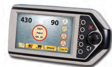
Figur 3. Systemet Motomit IQ från Parker stödjer StanForD 2010
