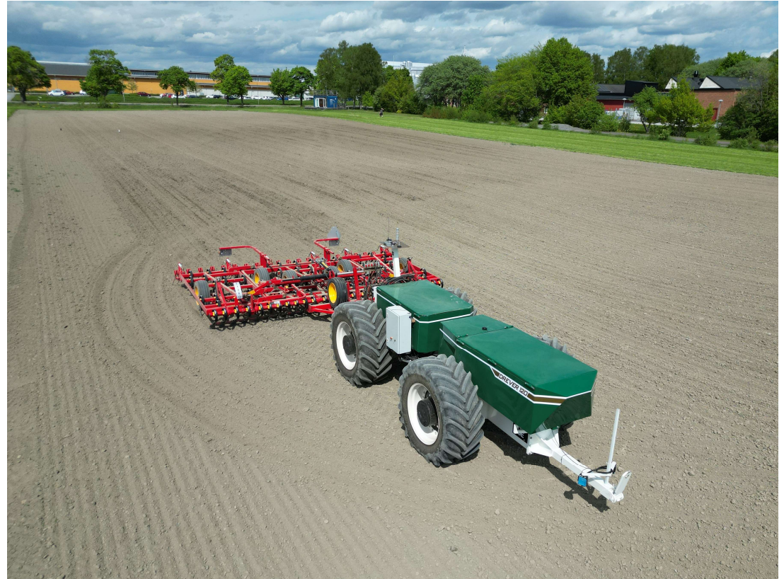
Prototyp 1 av Drever 120 av Traktoravid AB, Uppsala. RISE har hjälp till med batteri-, el-, och styrsystem. Nu är den testplattform på RISE testbädd
