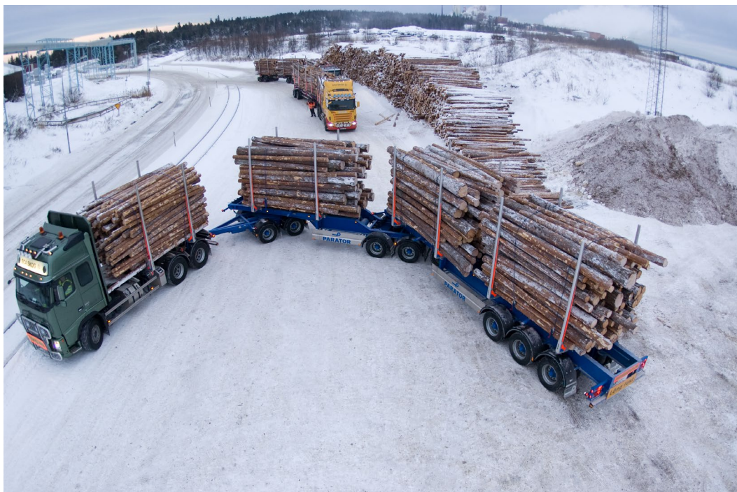
Figur 1. Den första ETT-bilen på terminalen i Överkalix efter lastning. Därefter väntar en resa på ca 16 mil till Munksund, Piteå.
