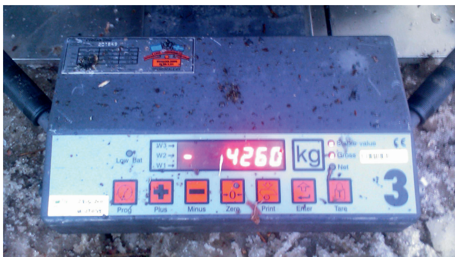
Lastvikterna kontrollerades bl. a. med fordonsvåg.
