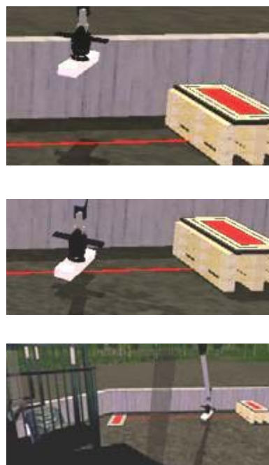
Figur 14. Överst: Rätblocket får inte föras över muren. Bilden visar maximal höjd. Mitten: Blocket får inte föras utanför linjen. Bilden visar maximal tillåten avvikelse inåt. Nederst: Vy från hytten.
