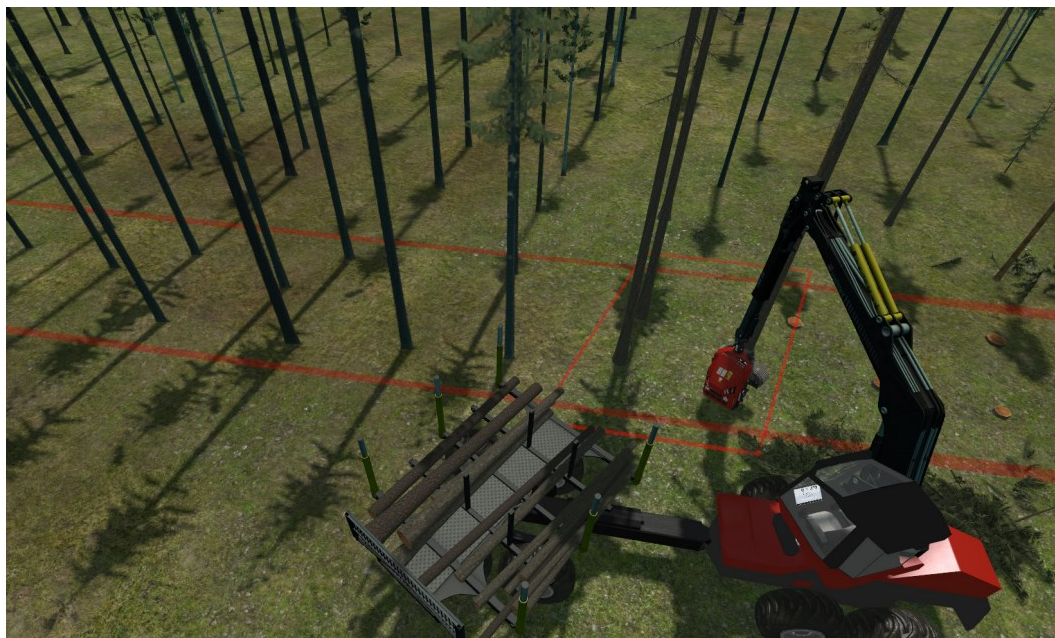
Figur 7. Pågående drivararbete i en virtuell skog. Som ett extra förarstöd markerades rekommenderat fällningsområde med en röd ram på marken. Detta stöd var tillgängligt hela tiden, oavsett om automatiska sekvenser användes eller inte. Figuren är från figur 1 i Manner m.fl. (2019a).
