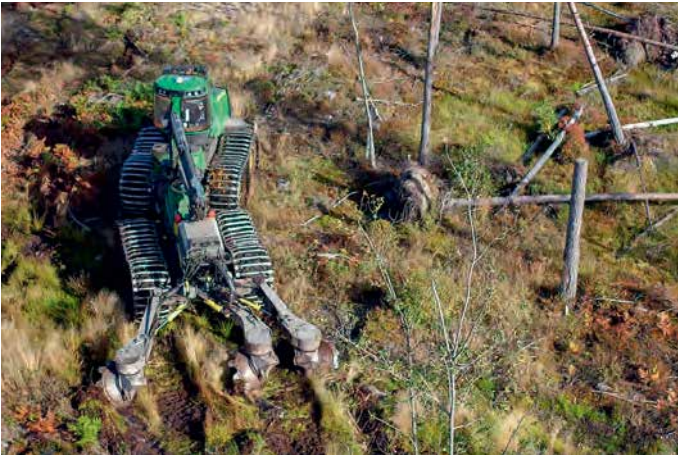
Markberedning försätter orsaka flest skador på lämningar.
