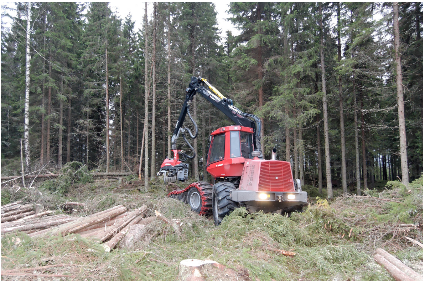
Figur 4. En Valmet 941 i slutavverkning. Foto: Skogforsk
