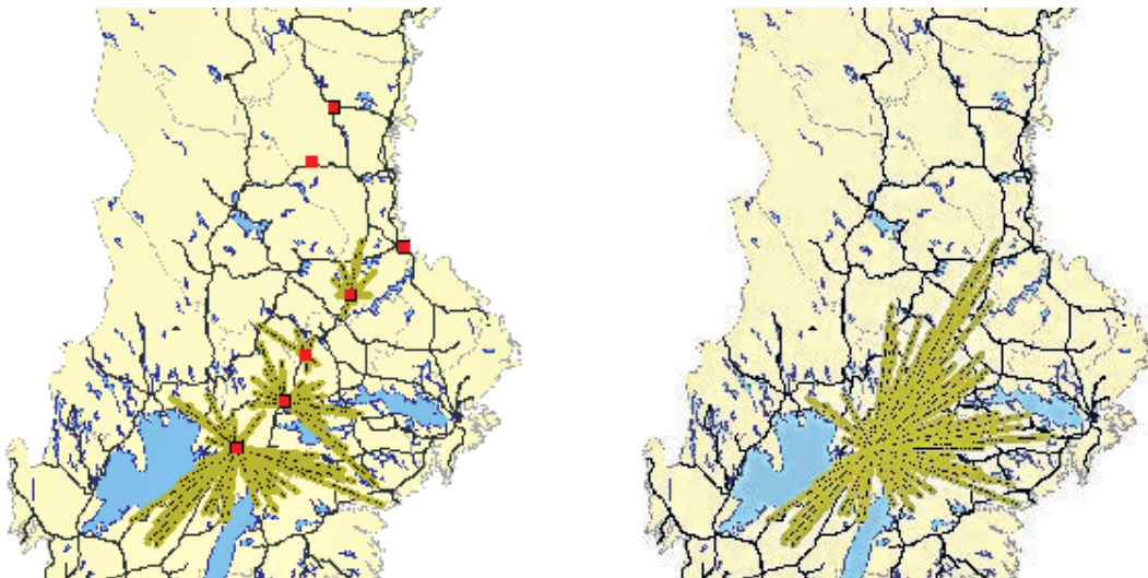
Figur 6. Optimala lastbilsflöden av ett sortiment till en mottagningsplats med och utan en tänkt tågpendel. Kartorna hämtade från ett uppdrag åt Sveaskog, Resultat nr 15, 2005.
