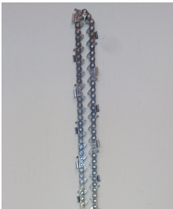
Figur 1. Bild på kedjan av full Skip-typ med 2/3 av en standardkedjas antal skärtänder.
