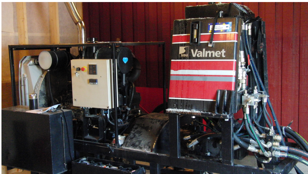
Figur 8. Testriggens dieselmotor till vänster i bild och hydraulaggregatet med tank till höger.
