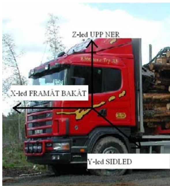
Figur 1. Vibrationerna mättes i x-, y- och z-led.
