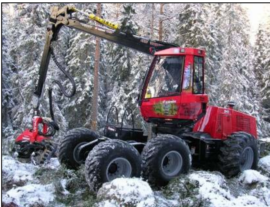
Figur 3. Engreppsskördaren Valmet 941. ( www.dalfors.se )
