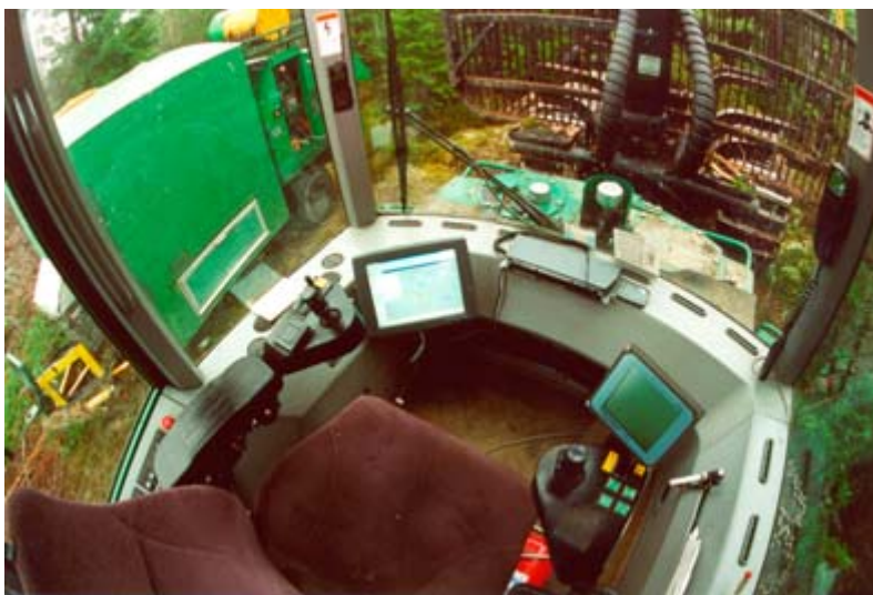
Figur 13. Fordonsdators placering i skotarhytten.
