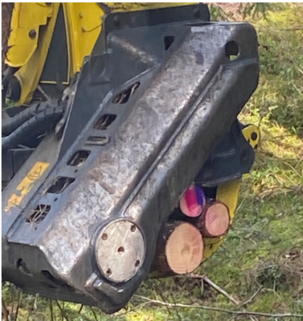
Figur 2. Bild av skördaraggregat under pågående test med färdig ackumulerad flerträdsbunt och färgmärkning på första stammen i bunt, så kallad referensstam. Efter att buntens släppts på marken, påbörjas kontrollmätning med enkelträdsupparbetning. Föraren börjar då med den färgmärkta referensstammen.
