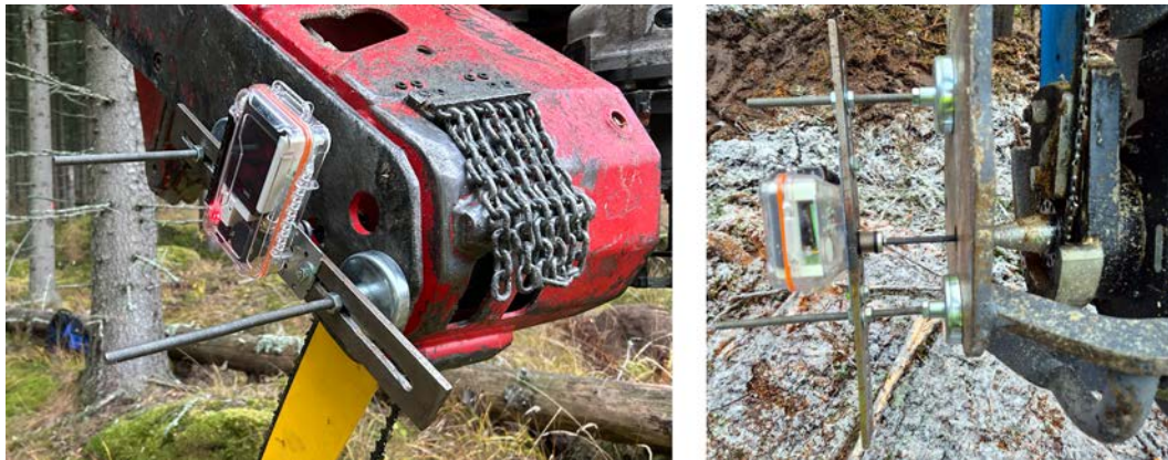
Figur 18. Pulsgivare ansluten till kedjehjulets nav för mätning av sågmotorns varvtal. Pulsarna samt deras tidpunkter loggades lokalt och streamades via bluetooth till en mobiltelefon, som också kontrollerade start- och stopptid för datainsamlingen. Foto: Björn Hannrup, Skogforsk.
