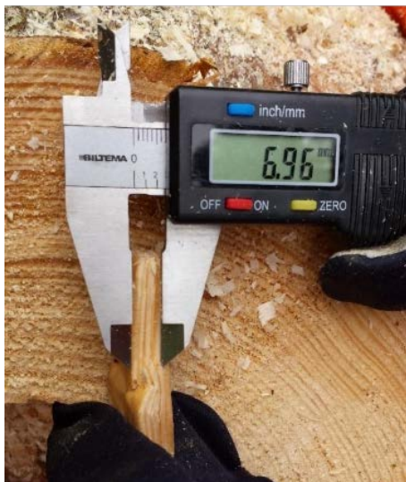
Figur 28. Mätning av inträngningsdjup för dubbskador.
