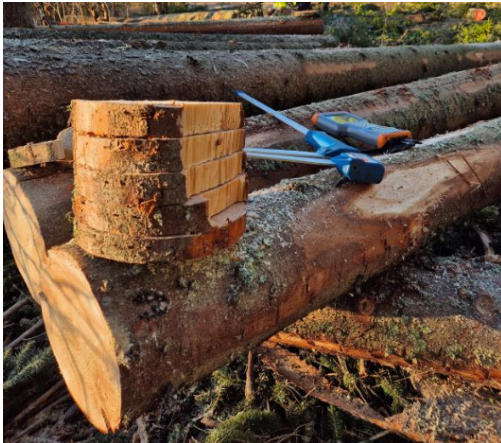
Figur 27. Illustration av trissmetoden. Trissorna är kapade ur samma stockände, och genom att summera trissornas tjocklek kan kapsprickans längd uppskattas. Foto: Björn Hannrup, Skogforsk.
