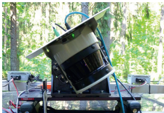
Den pulserande laserskannern – en spännande sensor
