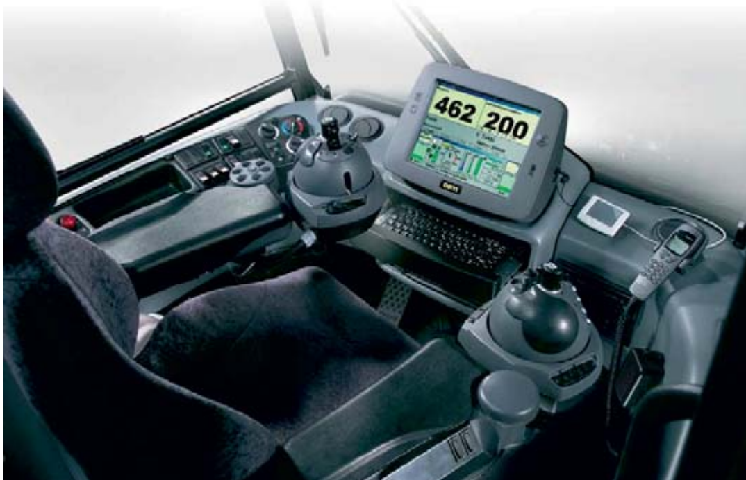
Figur 16. Hytt i skördare från Ponsse. Styrreglagen består av stora klot täckt av olika kontroller. Kranstyrningen sker genom tiltnings av klotet. Bild: Ponsse Plc.
