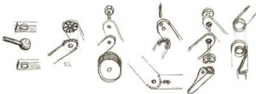
Figur 41. Olika lösningar för att låsa en led som kan utföra rotationsrörelse.
