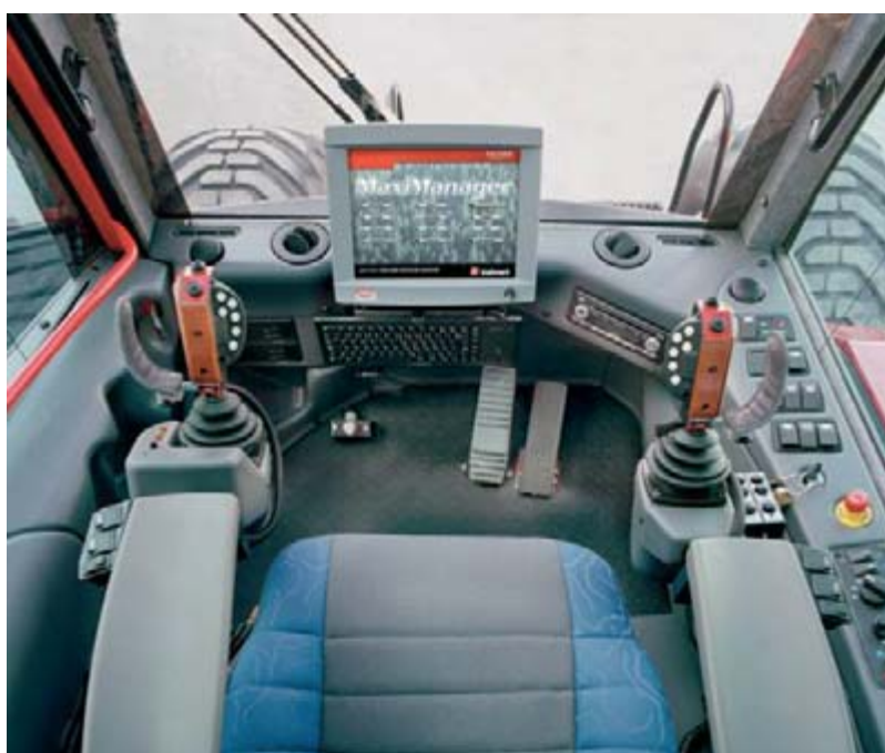
Figur 14. Valmet hytt med EME-spakar. Bild: Skogforsk
