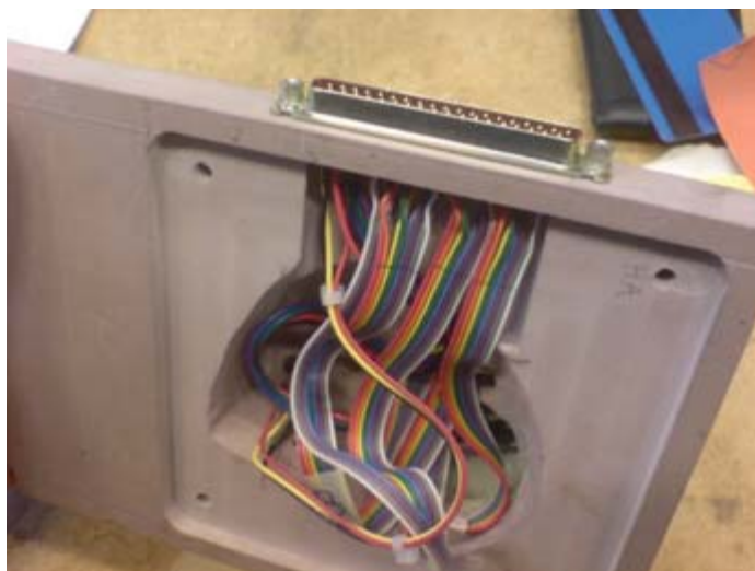
Figur 69. Reglagens kontroller kopplades till en D-sub.
