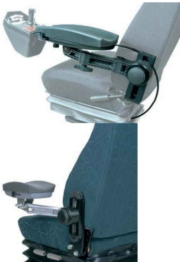
Figur 18. Två olika armstöd från företaget Sittab. På det vänstra sitter en reglagehållare med styrreglage av typen minispak. Bild: Sittab Stol AB.
