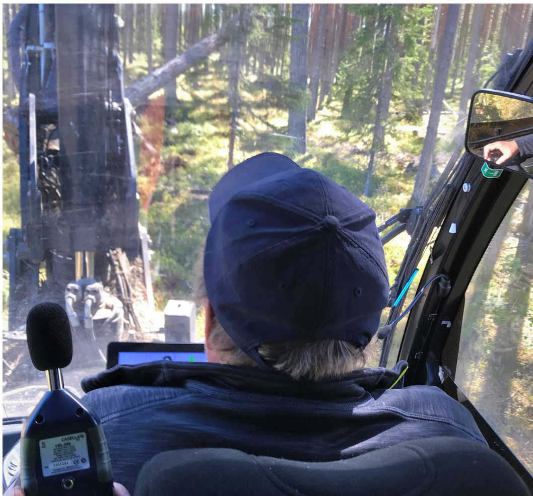
Figur 3:3. Bullermätning skedde inne i hytten med mikrofonen i närheten av operatörens öra, dels vid körning och dels vid avverkning och upparbetning på olika avstånd från hytten. Resultaten loggades till mättdator för senare analys.
