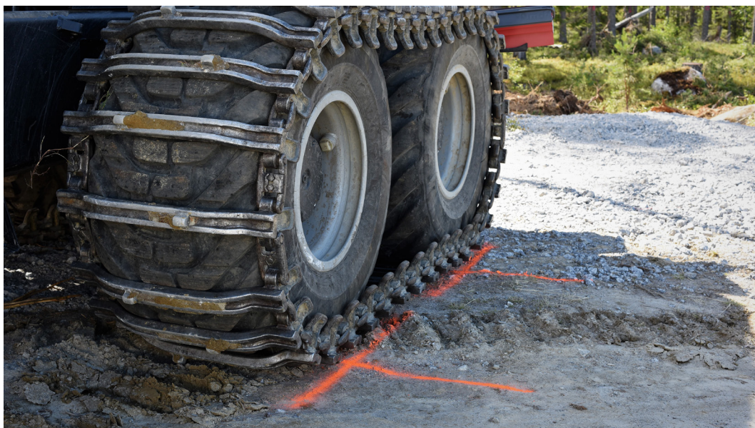
Figur 3:6. Bränslemätning gjordes genom toppfyllningsmetoden. Maskinens position markerades noggrant för samtliga hjul och aggregat.
