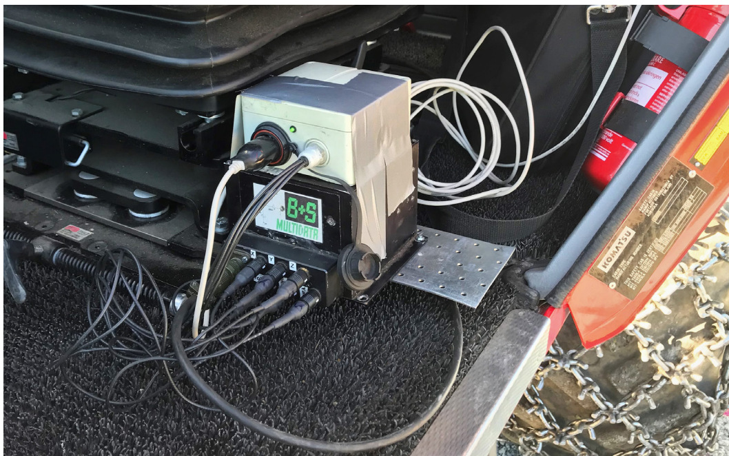
Figur 3:2. Vid mätningen av vibrationer monterades mätutrustningen på en spikplåt som sköts in mellan stolfundament och hyttgolv. För alla maskiner, utom Ponsse Bear, var det möjligt att sätta utrustningen linjerat med stolens riktning.
