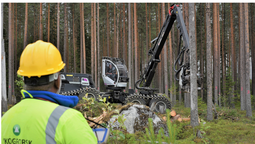
Figur 3:5. Logset 12H tidsstuderades från mark med träden uppmätta och märkta i förväg.
