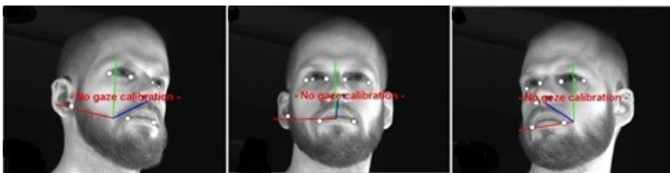
Figur 2. Exempel på bilder som samlats in med eye-trackingutrustning för bestämning av huvudrörelser.
