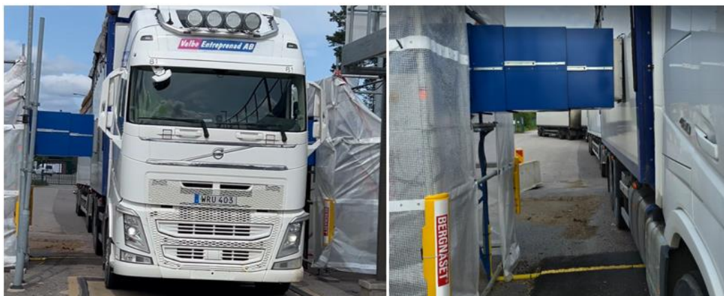
Figur 45. Vänster: Fotografi av flisbil under mätning. Höger: närbild på mäthuset och dess skyddsplåtar när den ligger dikt an mot skäppan. Foton: Radarbolaget.
