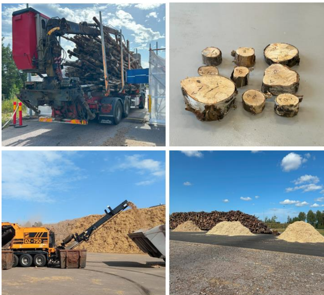
Figur 7. Foton från processen där trissmätning och uppflising jämförs som referensmetoder. Från vänster: mätning med mikrovågor, referenstrissor, uppflising, tre flishögar. Foton: Radarbolaget.
