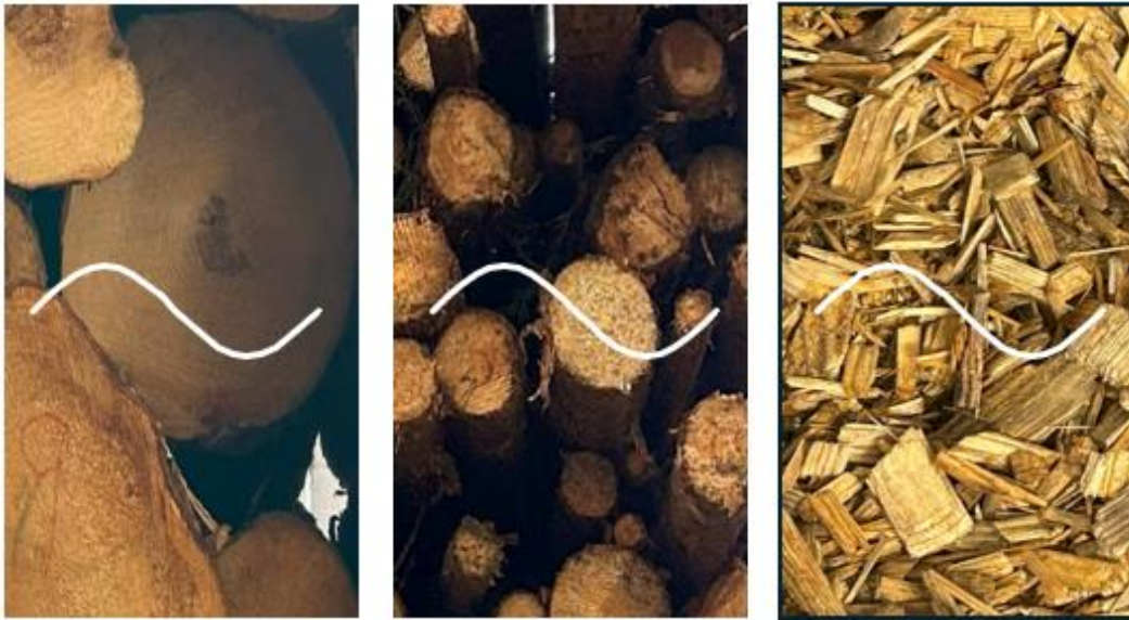
Figur 29. Visuell jämförelse av materialstorlek jämfört med våglängd. Vänster: Grovt rundvirke. Mitten: klenrundvirke. Höger: flis. Foton: Radarbolaget.
