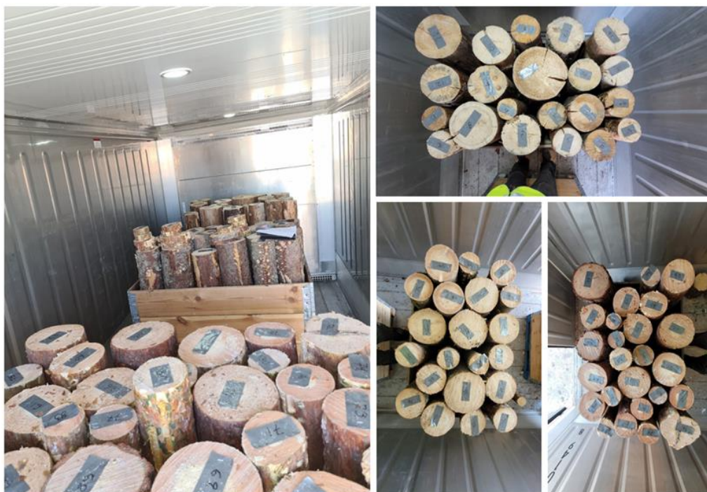
Figur 22. Försökupställning för studie av fastillståndets inverkan, där stockar i Fack A, B och C visas i containern. Foton: Radarbolaget.
