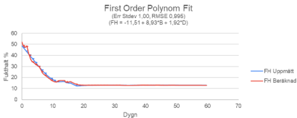
Figur A 27. Mikrovågsmätt + modellerad fukthalt samt referensmätt fukthalt som funktion av tid under torkning, baserat på initial signalbehandling.
