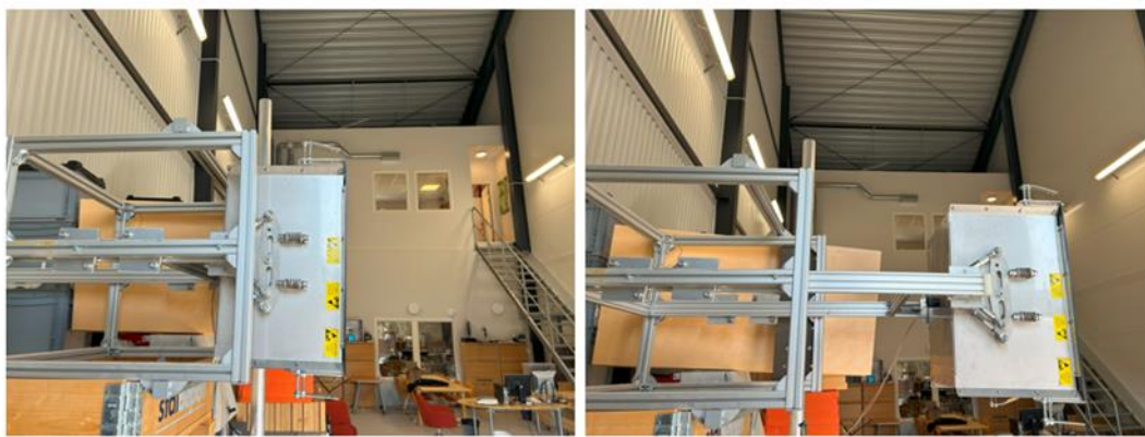
Figur 36. Vänster: antenn i viloläge. Höger: antenn transversellt utskjuten. Foton: Radarbolaget.
