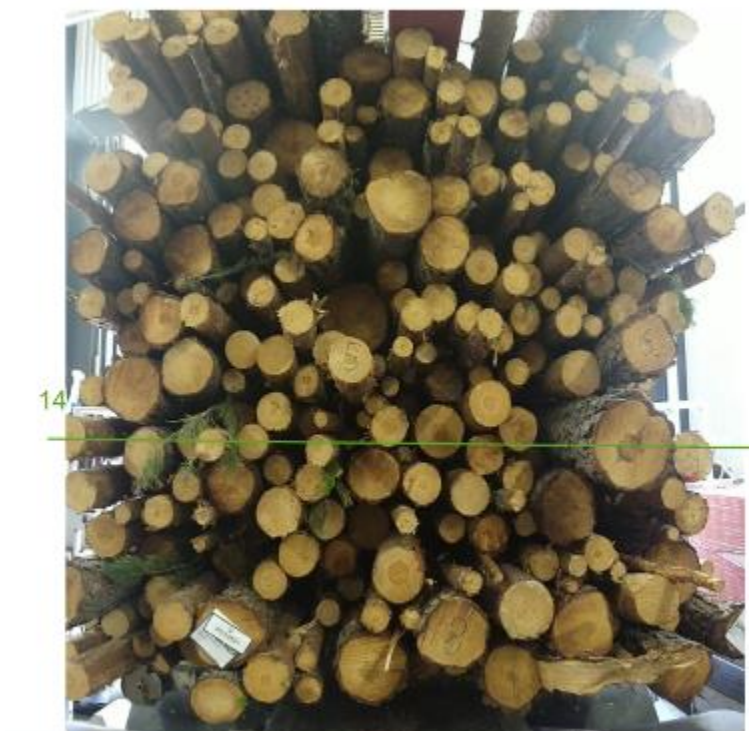
Figur A 33. Exempel på beräkning av medelstockdiametern hos klena stockar. Medeldiametern för stockarna längs den gröna linjen beräknades till 9 cm. Foto: Radarbolaget.
