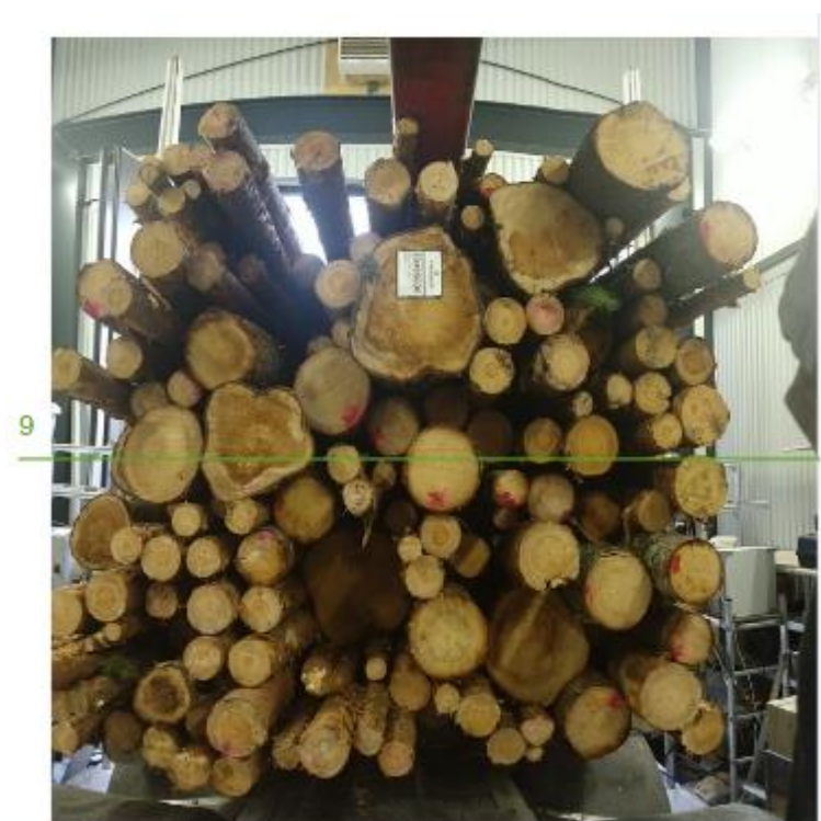
Figur A 34. Exempel på beräkning av medelstockdiametern hos klena stockar. Medeldiametern för stockarna längs den gröna linjen beräknades till 14 cm. Foto: Radarbolaget.
