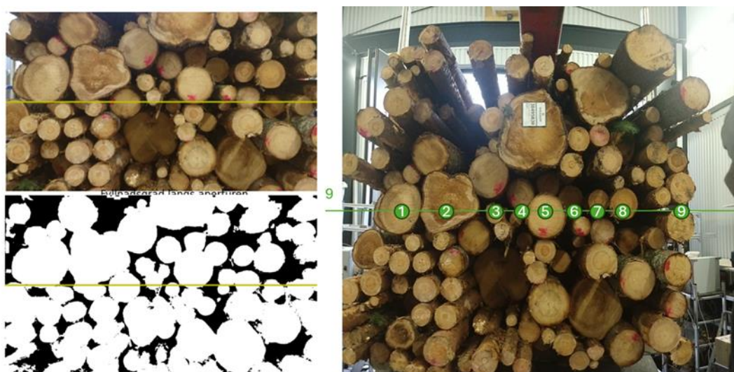
Figur 40. Vänster: bildanalys av packningsgrad. Höger: räkning av antal stockar mitt i bildens perspektiv. Foton: Radarbolaget.
