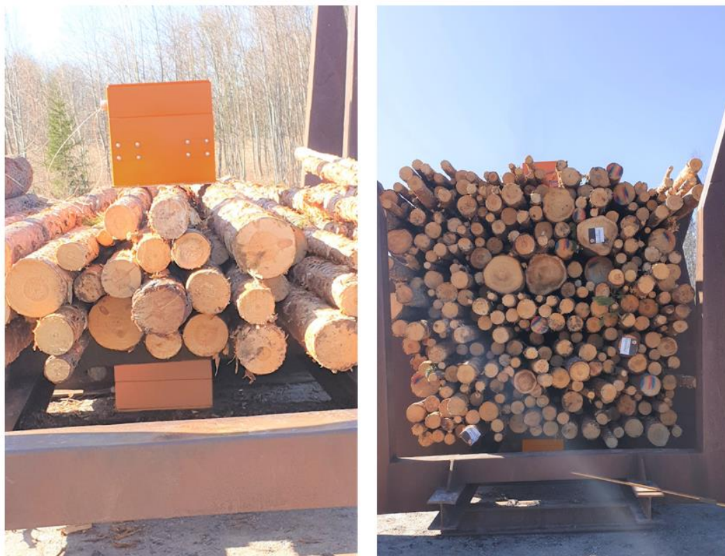
Figur 17. Antenner (orangea lådor) på vardera sida om olika mängd travad bränsleved. Vänster: mätning med ca 1 m virkeslängd. Höger: mätning med ca 3 m virkeslängd. Foto: Kari Hyll, Skogforsk.
