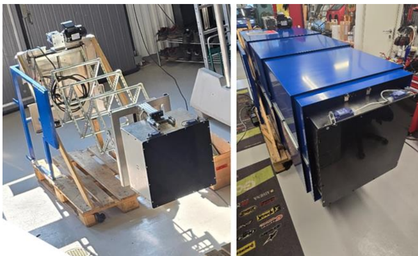
Figur 49. Saxmekanik med och utan skyddsplåtar. Foton: Radarbolaget.
