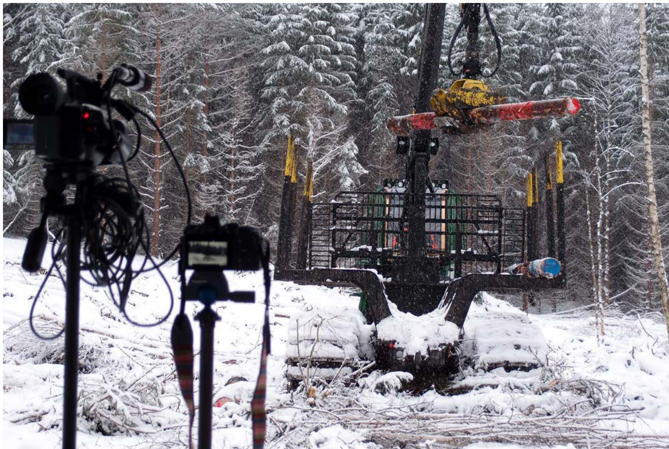
Kranspetsstyrning finns redan ute på marknaden. Men studierna fortsätter för att utveckla systemet ännu mer i jakten på högre produktivitet i skogsbruket.
