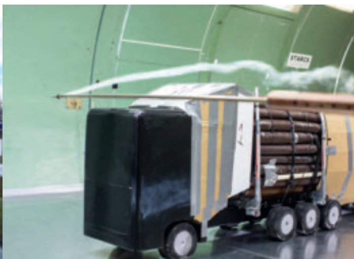
Fröjds Åkeri i Kisa äger en av testbilarna som utformats med en större hyttdeflektor på basis av testerna i vindtunneln. Den ska också få en sköld mellan framstam och första stakpar.
