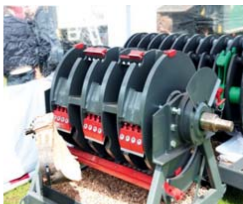
Figur 2. Trumhugg med öppen trumma och flera knivar, knivarna täcker bara en del av trummans bredd och sitter spridda runt trumman antingen i rader eller i spiralform.
