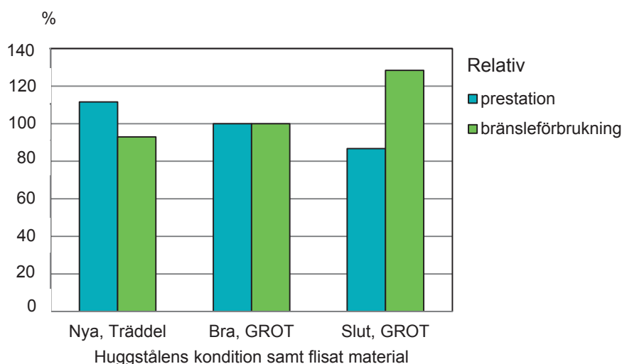
Figur 6. Relativ bränsleförbrukning och prestation för Jenz HEM 561 beroende på huggstålens kondition samt det flisade materialet.
