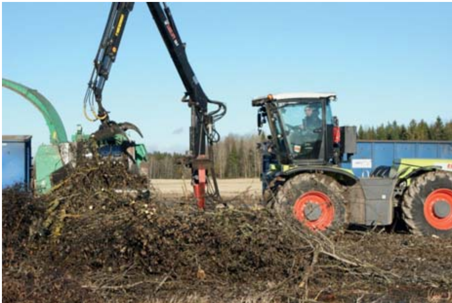
Figur 3. Jenzhuggen vid flisning av klenträäd.
