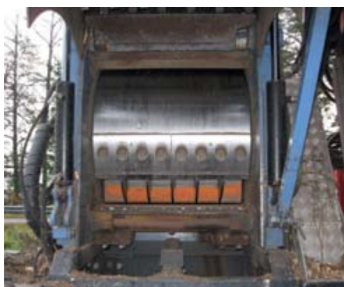
Figur 1. Trumhugg med sluten trumma och två knivar, knivarna är lika breda som trumman och sitter diametralt motsatta på trumman.
