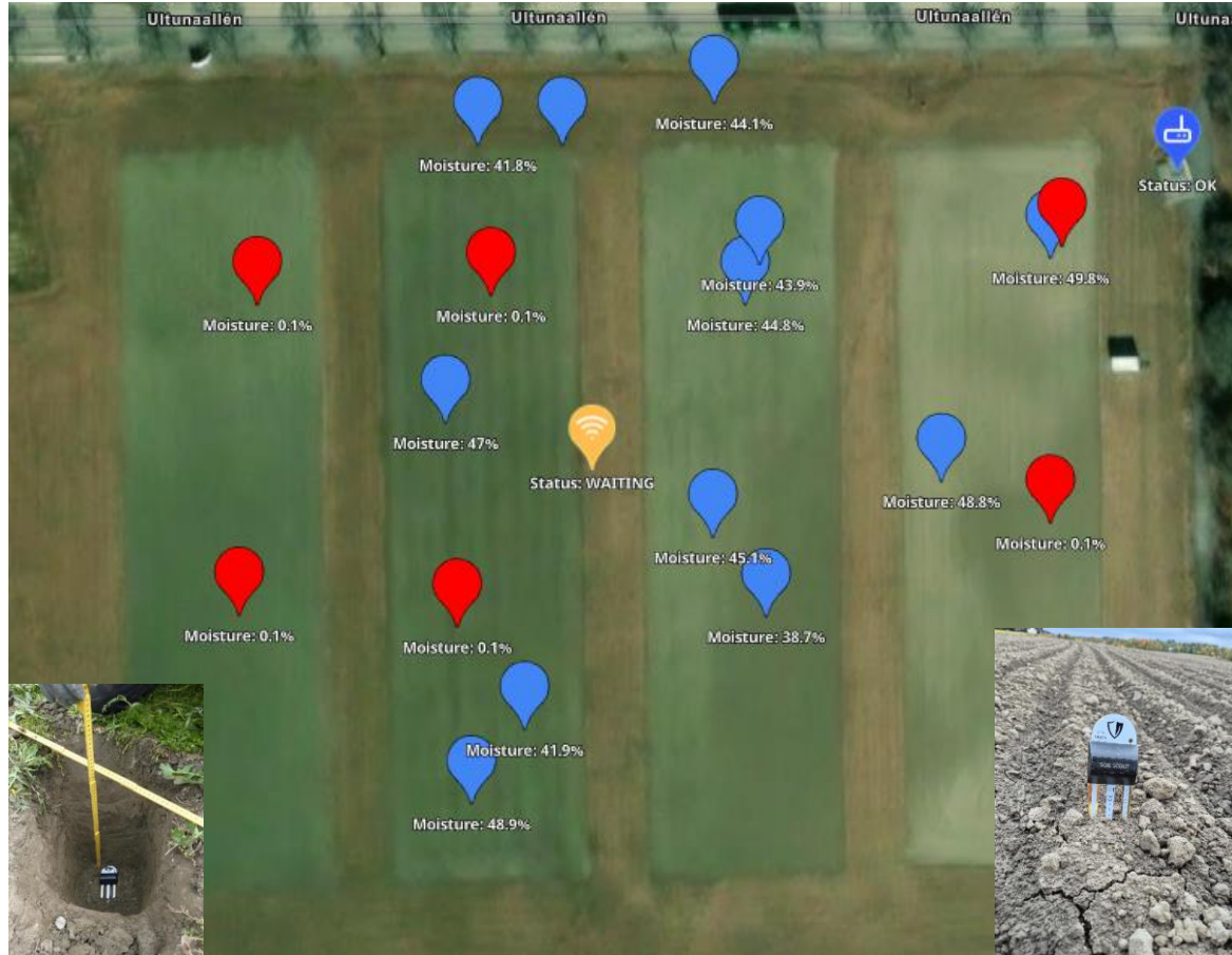
Jordsensorer: Vattenhalt och temperatur på olika djup
