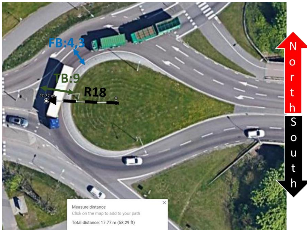
Figur 21: Trafikplats F Dropformand, ytterradie på 18m och med 120 graders vänstersväng ( öst till syd) R20 om yttre lågfartsektionen används.
