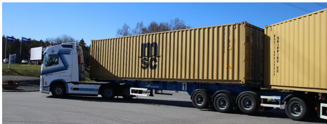
Figur 27 Långlink i HCT-II projektet 2022, 2 lyftbar och 1 styrbar axel på linken, 1 lyftbar på dragbilen
