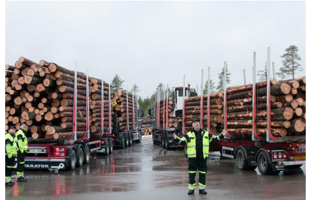
Skillnaden mellan 74 ton, till vänster och 60 ton, till höger. Foto: Skogforsk.
