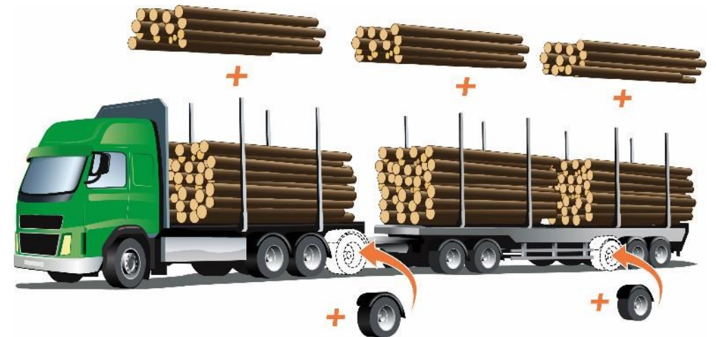
Med två extra axlar kan bruttovikten ökas med 10 ton. Illustration: Skogsindustrierna
