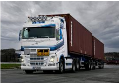
Figur 24: Långlink med 2 styrda axlar alternativt 1 lyft & 1 styrd axel på linken, klarar sväng och stabilitetskrav
