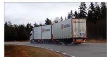
Figur 25: DUO-trailer med 1 styrd axlar på 1a påhängsvagnen, klarar sväng och stabilitetskrav.
