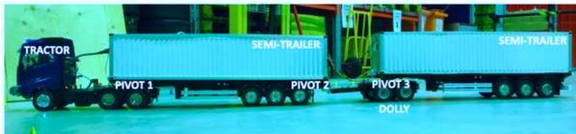
Figur 54. Skalmodellen som användes för rapid prototyping i labbet (Parshetti et al, 2021).
