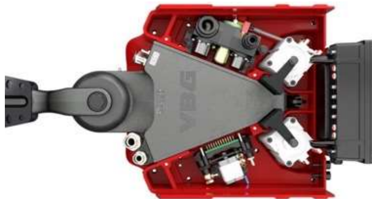
Figur 59. MFC-koppling som medger automatisk tillkoppling av släp. Dragstången med kilen till vänster skjuts in i den röda delen varpå kilen låses fast och el och luft kopplas in (VBG).
