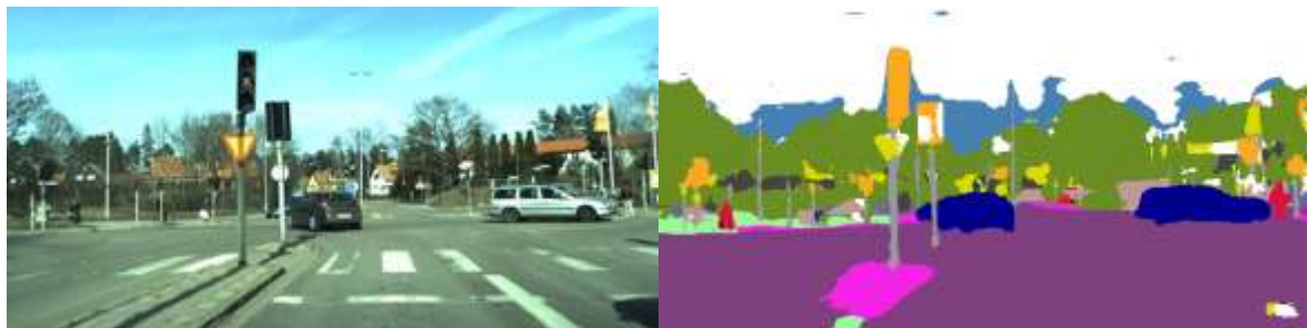
Figur 37. Input (till vänster) och output (till höger). Varje färg i output-bilden representerar en typ av objekt (Combitech).
