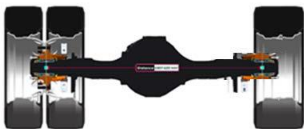
Figur 16: Tvärsnitt av axel och däck, vänster sida visar hur dubbelmontagen var monterad höger
