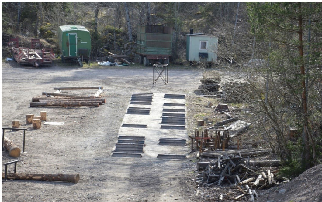
Figure 2. The vibration test track in Jälla, outside Uppsala. Foto: Rolf Björheden, Skogforsk.
