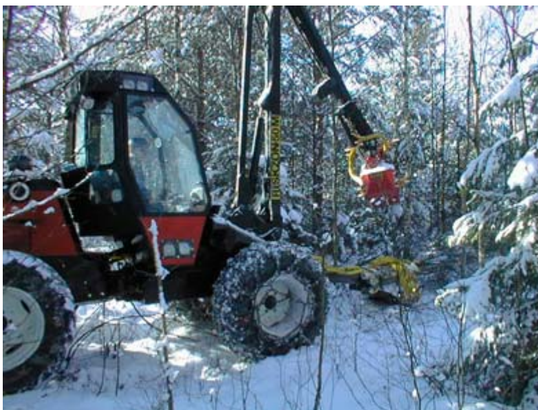
Figur 7. Valmet 701 med EnHar-aggregat.
