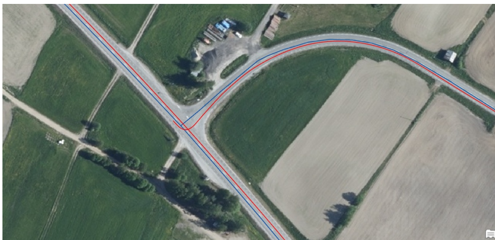
Figur 6. Geometrin för körspåret följer mätfordonets position i ett specifikt körfält.
