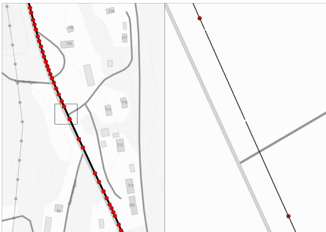
Figur 10. Till vänster visas filterade punkter i rött på teststräckan i svart. Den svarta rutans område återges i bilden till höger, där varje ofiltrerad punkt är svart och de filterade röda. De svarta punkterna ligger mycket tätt.
