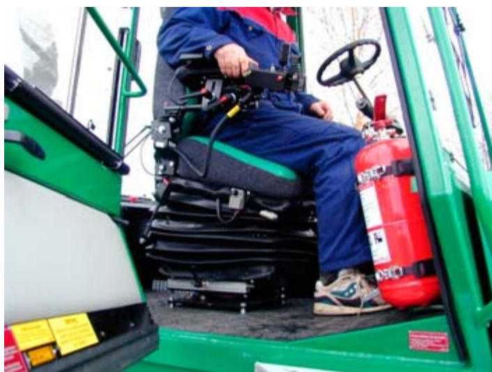
Figur 5. KAB-stolens möjligheter att tiltas stolsdynan underlättar en hög sittställning.
