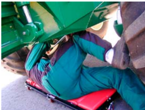
Figur 8. Servicepunkter som kräver krypande under maskiner bör undvikas.
