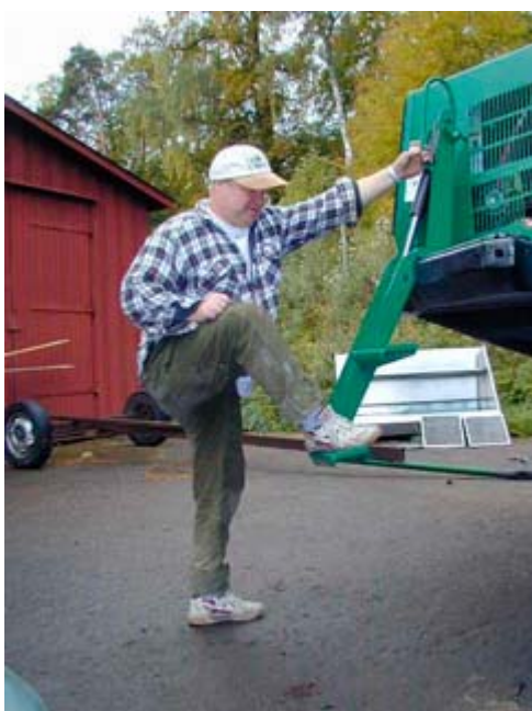
Figur 1. Högt placerat fotsteg försvårar påstigning.
