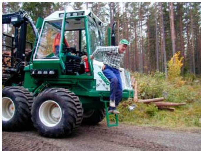
Figur 2. Dålig lutning på stegen försvårar avstigning.
