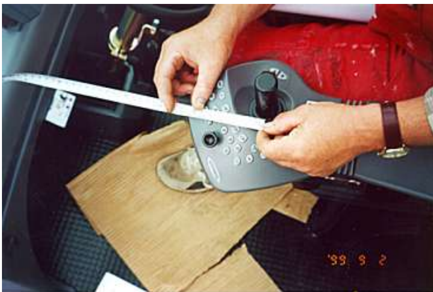
Figur 6. Avståndet mellan spak och knappar bör kunna justeras.
