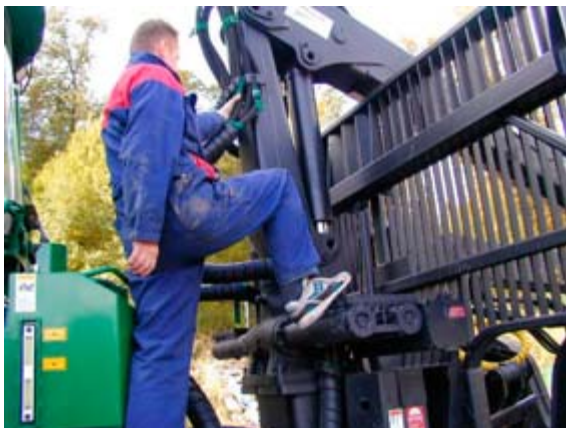
Figur 7. Kran bör vara försedd med smörjrör för att undvika klättrande.
