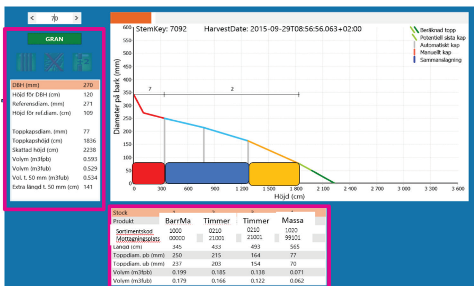
Figur 6. Mät- och sortimentsdata registreras standardmässigt i skördarnas produktionsfiler (hpr-filer). Exemplet visar en liggande granstam med fyra tillredda stockar. Rutan till vänster visar registrerade stamdimensioner och volymer och rutan nedanför registrerade stockegenskaper. I produktionsfilen kopplas data från varje tillredd stock med identitetsuppgifter som sortiment, mottagningsplats och virkesorder. Trädens koordinater (vanligen maskinens koordinater under tillredningen) och avverkingstidpunkten kan också registreras i produktionsfilen.
