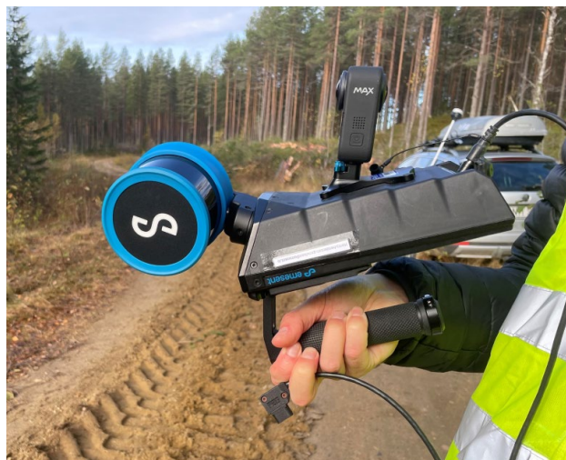
Figur 7. Handhållna MLS systemet Hovermap STX från Emesent användes för att skanna skogen innan avverkning. Den blå "burken" längst fram är själva laserskannern.
