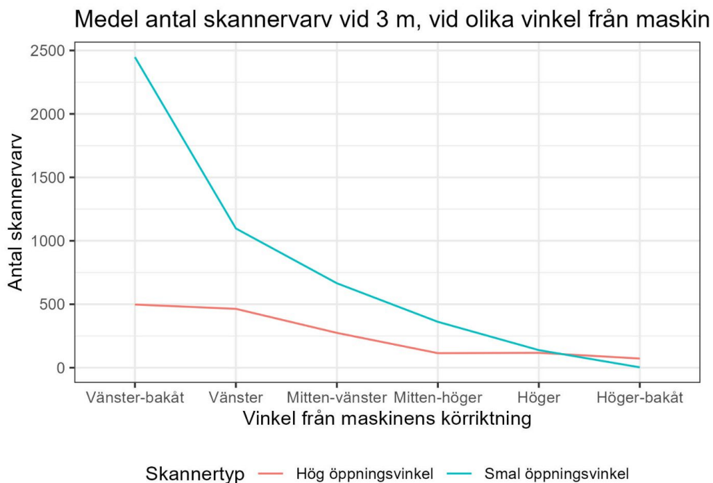
Figur 18. Antal skannervarv där stam detekterats vid 3 meter över marken (medeltal), fördelat över olika riktning från maskinens körriktning och skannertyp. Mitten är rakt fram, kranen sitter till höger, medan skannern sitter monterad på hyttens tak till vänster.
