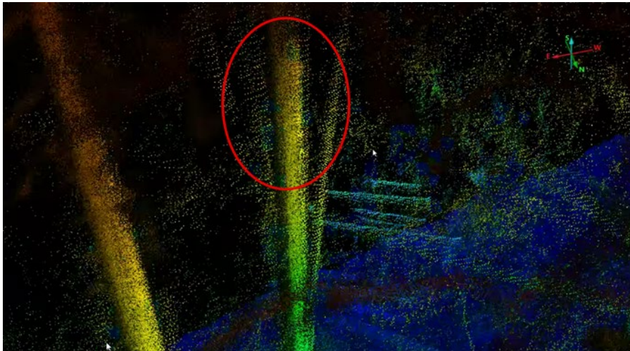
Figur 14. Punktmoln producerat med SLAM innehåller på ett antal ställen punktmoln med svajande träd.
