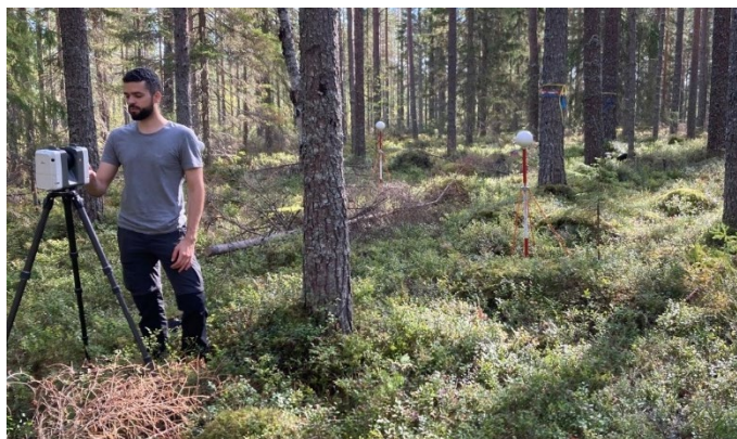
Figur 4. TLS under mätning i skog. Skannern står still på stativ och flyttas runt i skogen.
