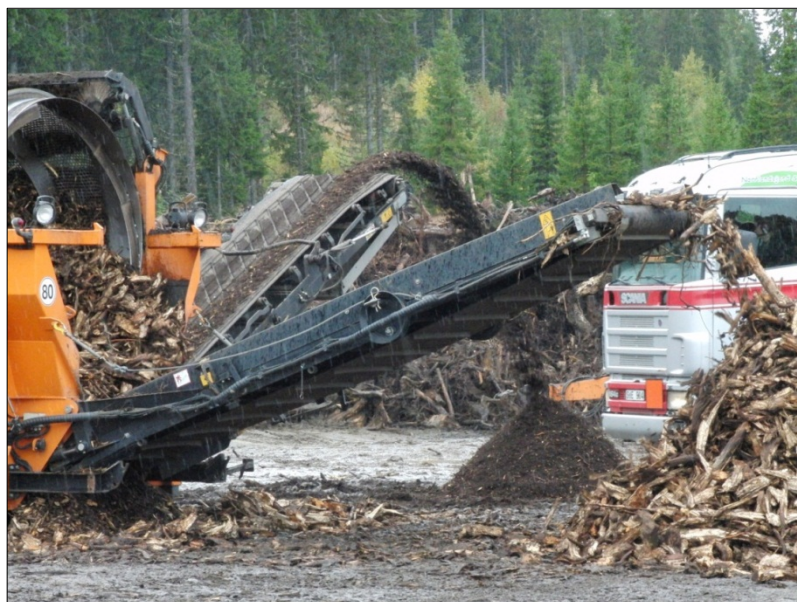
Figur 2. Sållet sett bakifrån. Acceptmaterialet hamnar i en hög bakom sållet (högen i höger bildkant) medan rejektet hamnar på sidan om sållet (den bakre högen i bilden).
