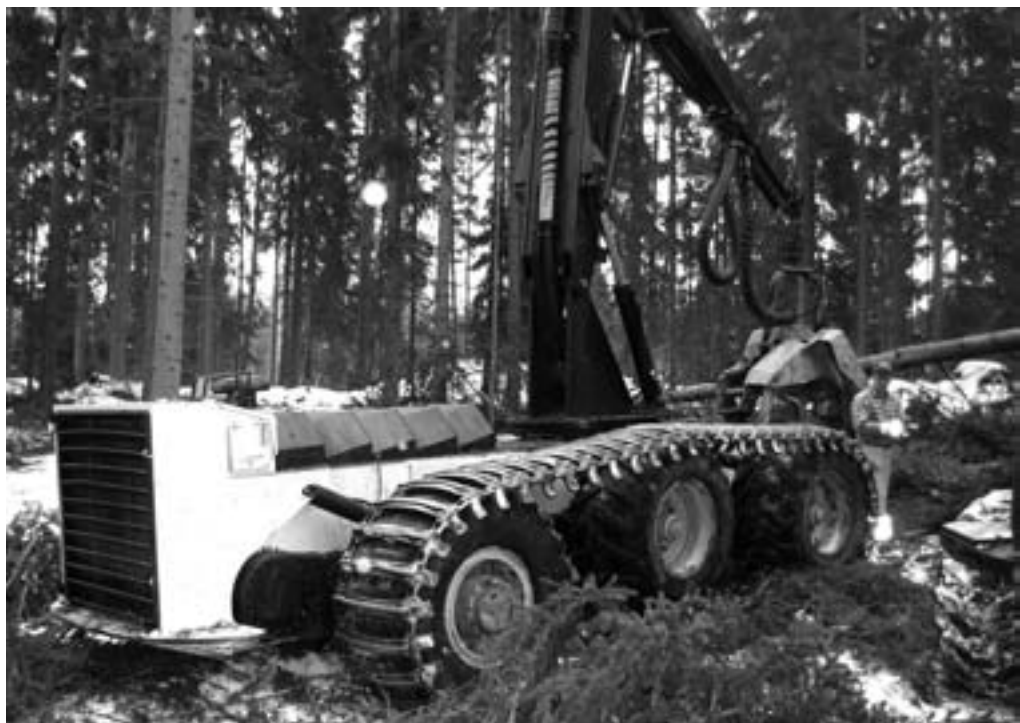
Figur 14. Besten – en radiostyrd avverkningsmaskin som skulle kunna tillverkas i röjningsutförande, dvs. en mindre maskin med röjaggregat i stället för kran. Foto Johan Heurgren.
