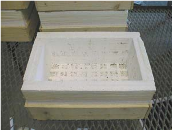
Figur 2. Specialtillverkad låda med dubbla polystyrenskikt för isolering av rotklumpen.
