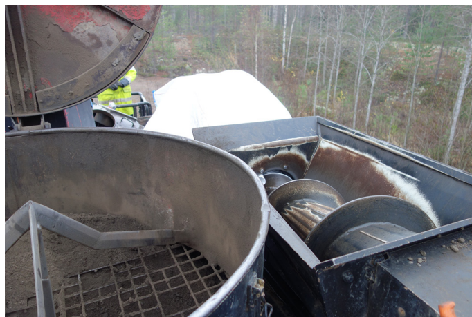
Figur 6. Säckarna spräcks och askan faller ner i påfyllningsanordningen. Säckarna läggs sedan i skruven till höger och kompakteras i en enda säck. Foto: Skogforsk.
