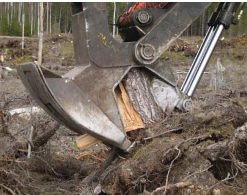
Pallari 140 är ett klippande aggregat. Den monteras enkelt i grävmaskinens skopfäste och kräver således ingen specialkonstruktion för infästningen.
