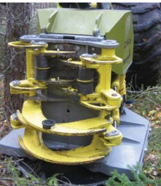
Bracke C16. Fällhuvud med sågklinga. Aggregatet saknar matarhjul. Ackumuleringsfunktionen är relativt tillförlitlig.
