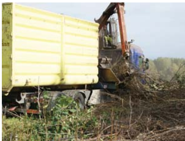
Bruks lastbilsmonterade flishugg 805, flisning av grot.
