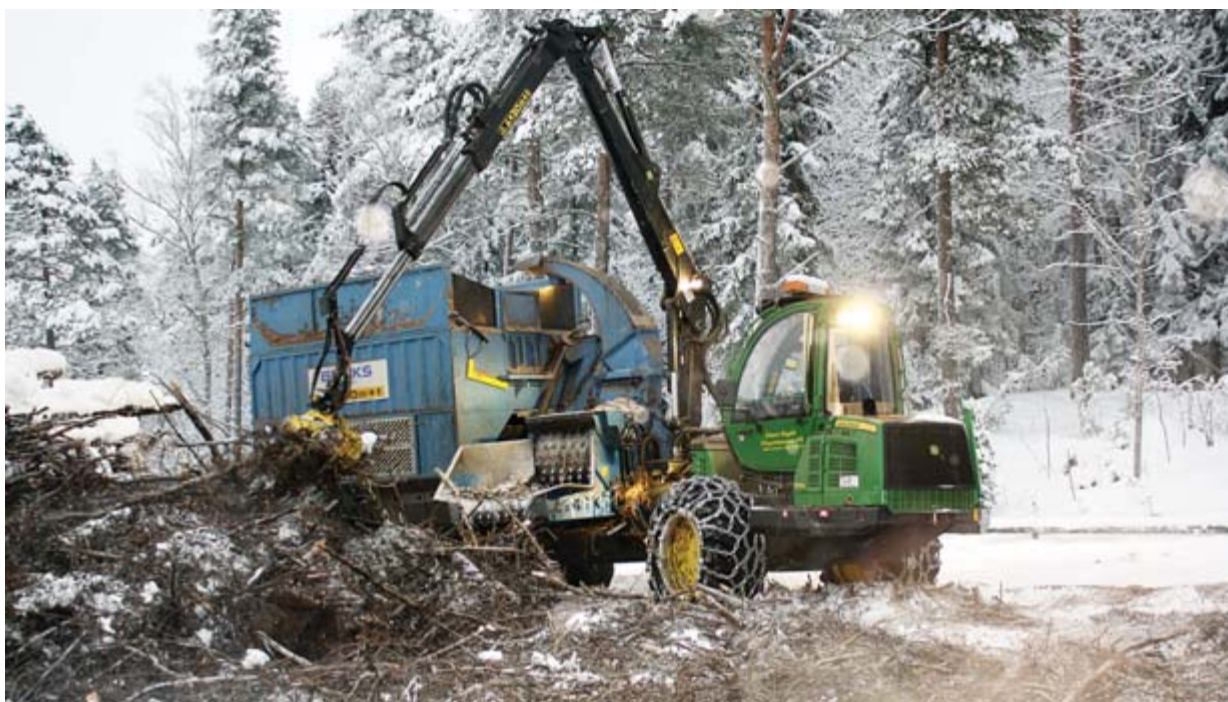
Flisning på avlägg med traktormonterad hugg är vanligt förekommande. Nackdelen med systemet är kostnaderna för flytt av utrustningen mellan olika objekt.
