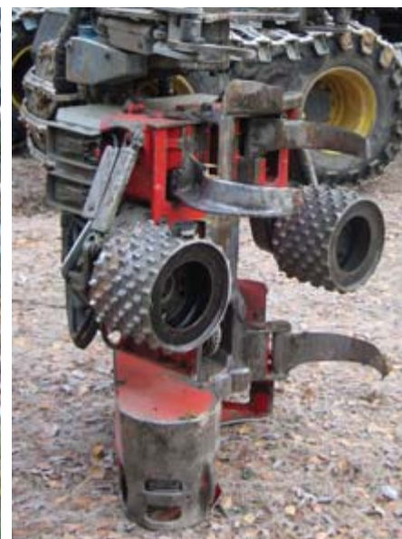
Log Max 4000 B skördaraggregat med sågsvärd och matarvalsar. Ackumuleringsfunktionen är tillförlitlig.
