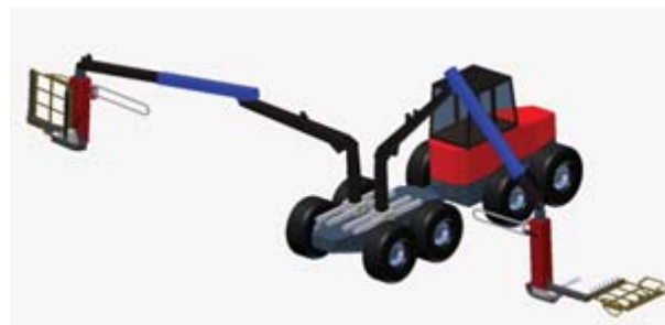
Idéskiss på tänkbar utformning av en specialiserad krankorridor-skördare för produktion som ger god ekonomi även i så klena bestånd som ner mot ca 6 cm brösthöjdsdiameter.
