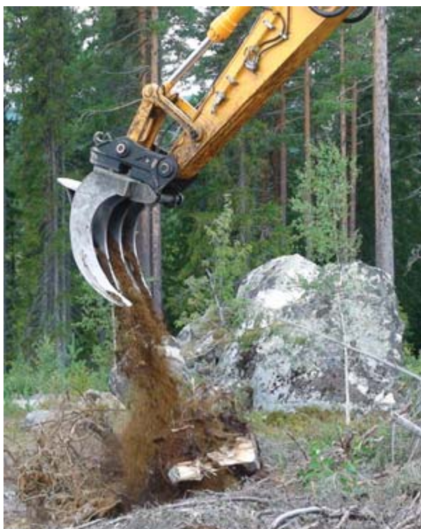
Aalto-grepen har den konstruktionsmässigt enklaste lösningen på ett stubbaggregat. Den monteras direkt i skopfästet och kräver således ingen extra hydraulik.
