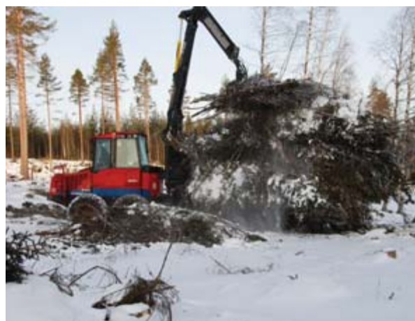
Skotning av grot med konventionell skotare.
