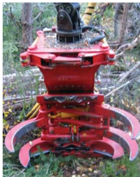
Naarva-Grip 1500-40E. Fällhuvud med klipp. Aggregatet saknar matarhjul. Ackumuleringsfunktionen är tillförlitlig.
