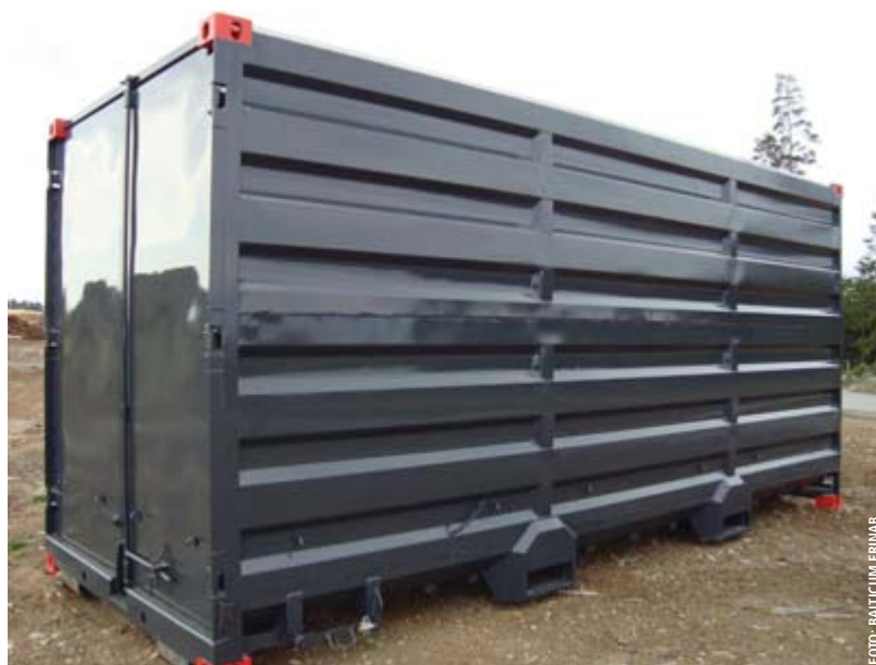
Konventionell lastbilscontainer där tunnlarna för hanteringstruckens gafflar ses i nederkanten på containern.
