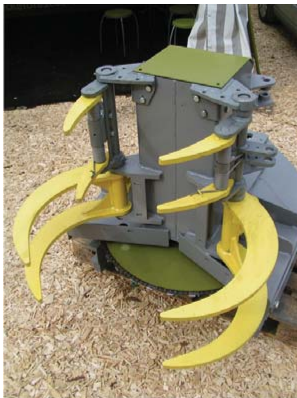
En tidig modell av Bracke C16a, marknadens kanske bäst utvecklade aggregat för geometrisk skörd i unga, täta skogsbestånd. Redan i dagsläget kan man i mycket klena bestånd med detta aggregat komma upp i en produktion vid fällning och sammanföring på ca 4,5 ton TS/G 0 -timme (9 m 3 f biomassa/G 0 -timme och 500 träd/G 0 -timme). Foto: Tomas Nordfjell, SLU.
