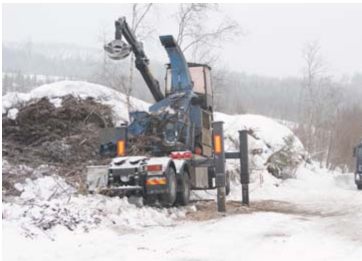
Hugglinken i gång med flisning respektive stående överksam på avlägget i väntan på att flisbilen ska återkomma efter en flisleverans.
