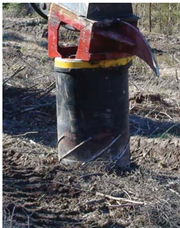
Fräsen lösgör stubben genom att fräsa av sidorötterna med den roterande trumman.
