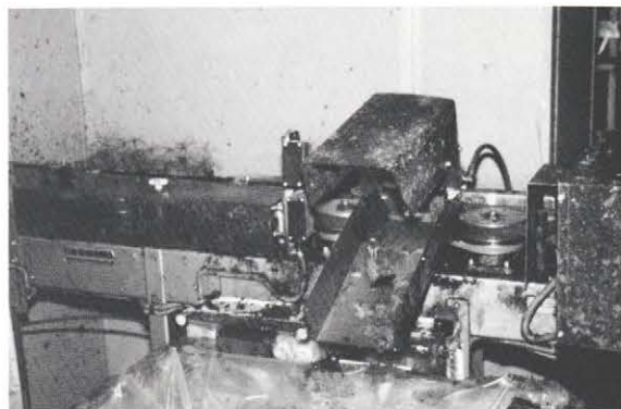
Bild 4. Sorteringsenheten: tryckluft stöter ut underkända enheter.
