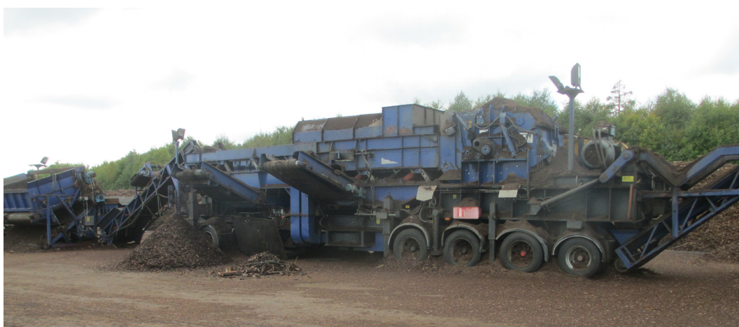
Figur 5. Det använda sållverket från Bollsta Teknik AB. Högen längst till vänster är finmaterialet, därefter kommer sten och annat tyngre material. Till höger utanför bild är acceptmaterialet. Foto: Henrik von Hofsten, Skogforsk.
