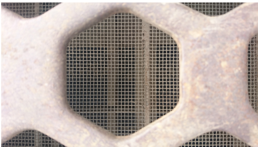
Figur 3. Det finare 8 millimetersållet sett igenom ett av de grövre 80 millimetershålen från den övre sällplåten. Foto: Henrik von Hofsten, Skogforsk.
