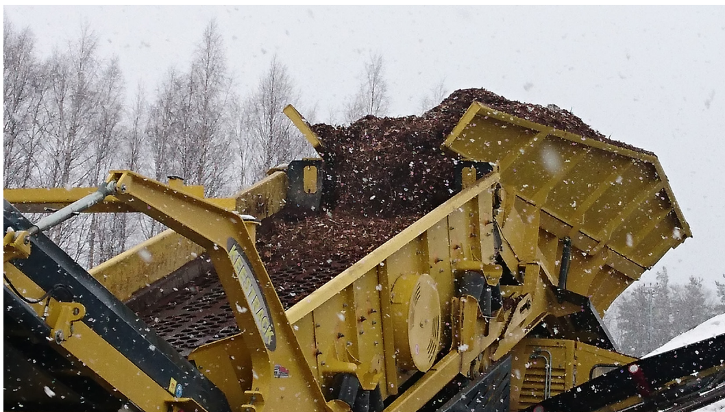
Figur 2. Sällverkets inmatningsficka längst upp och den grövre, sluttande och vibrerande sällplåten. Foto: Henrik von Hofsten, Skogforsk.
