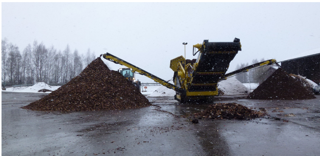
Figur 1. Sållverket Keestrack Frontier K6 med finfraktionshögen till höger, övergrovt material i mitten och acceptmaterial till vänster. Foto: Henrik von Hofsten, Skogforsk.
