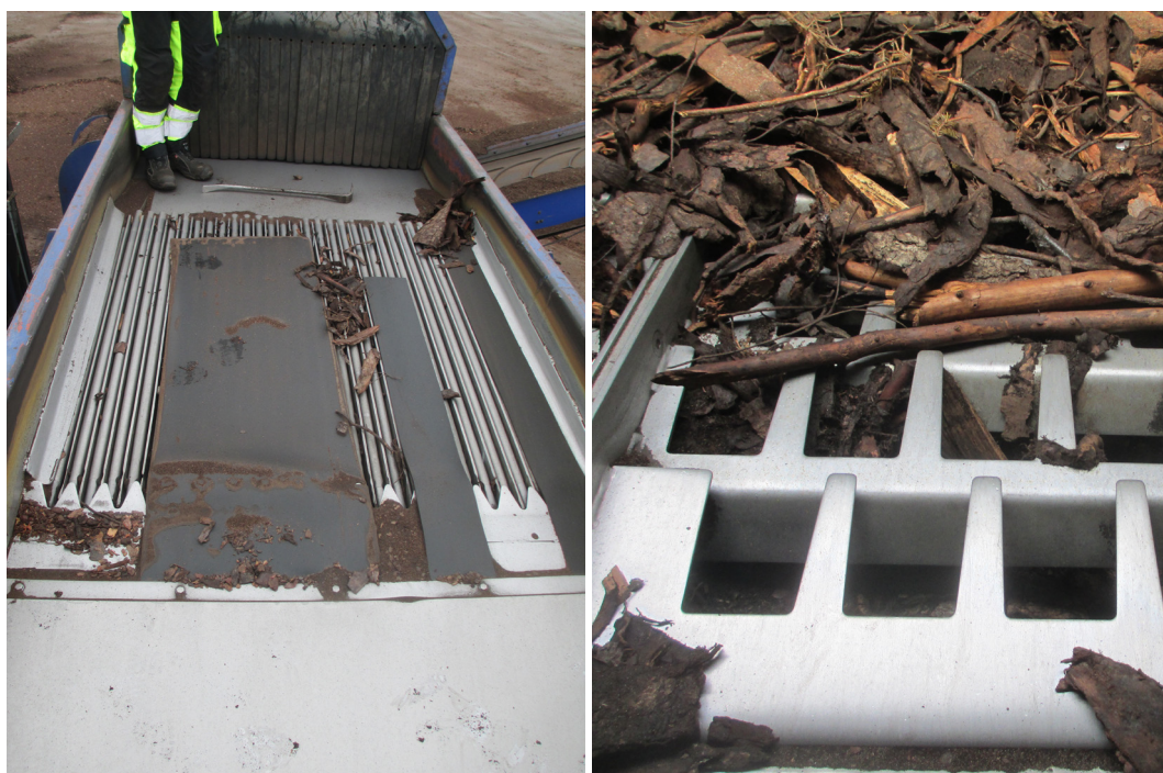
Figur 6. Spaltsållet till vänster och fingersållet till höger. Spaltsållet är delvis övertäckt av gummidukar för att inte allt för mycket av det brännbara finmaterialet ska falla igenom. Foton: Henrik von Hofsten, Skogforsk.
