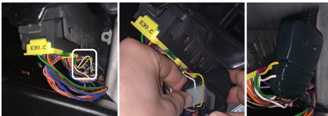
Figur 2. CAN-bussens kabelpar identifieras och den induktiva CAN-signalgivaren monteras.
