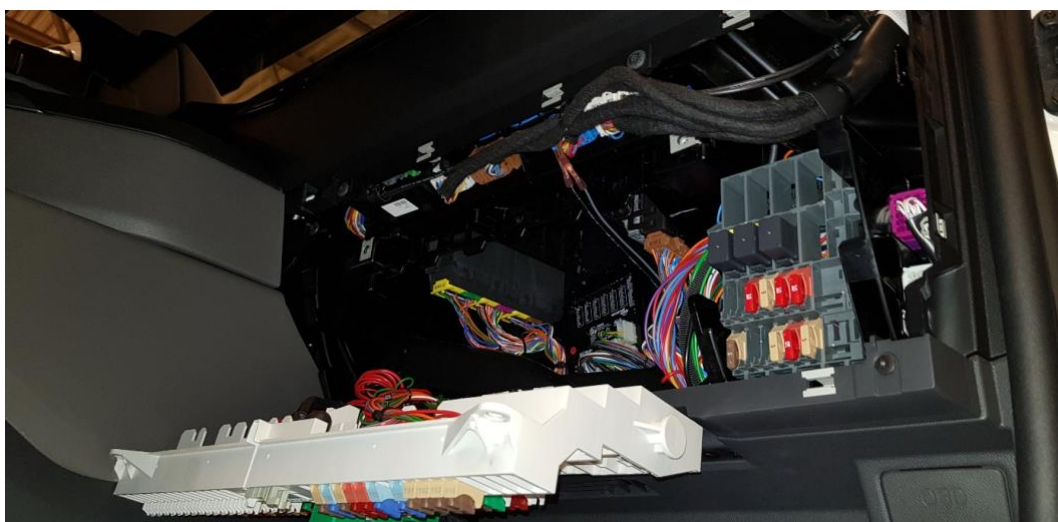
Figur 1. Först friläggs kabelstammen bakom säkringsplinten under instrumentbrädan.
