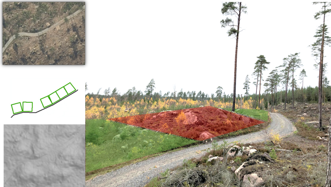
Figur 5. Ett av avläggen som besöktes i fält där det tydligt framgår varför en avläggsruta inte passerade lämplighetstestet (den röda rutan). Orsaken var att höjdskillnaden mellan terrängen i den röda rutan och vägbanan översteg två meter. I bilderna till vänster visas samma skogsbilväg/avlägg från ovan, där den översta bilden är en översiktbild, den mellersta bilden visar vilka avläggrutor som var lämpliga och den nedre bilden visar den digitala höjdmodellen.
