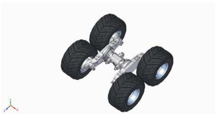
Figur 2. En skotarboggi bestående av en differential, två boggilådor samt fyra hjul.
