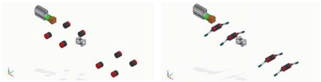
Figur 102. Två möjliga konfigurationer för elmotorer och transmissioner i koncept US7.
