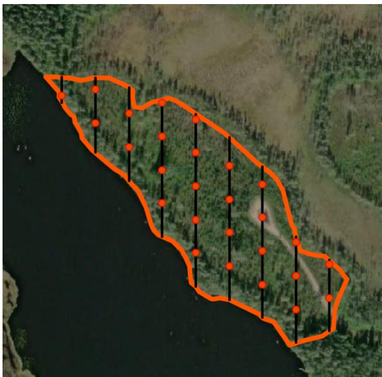
Figur 2. Kartvy för bestånd i appen Field Maps där beståndsgräns och fördefinierade inventeringspunkter markerats.
