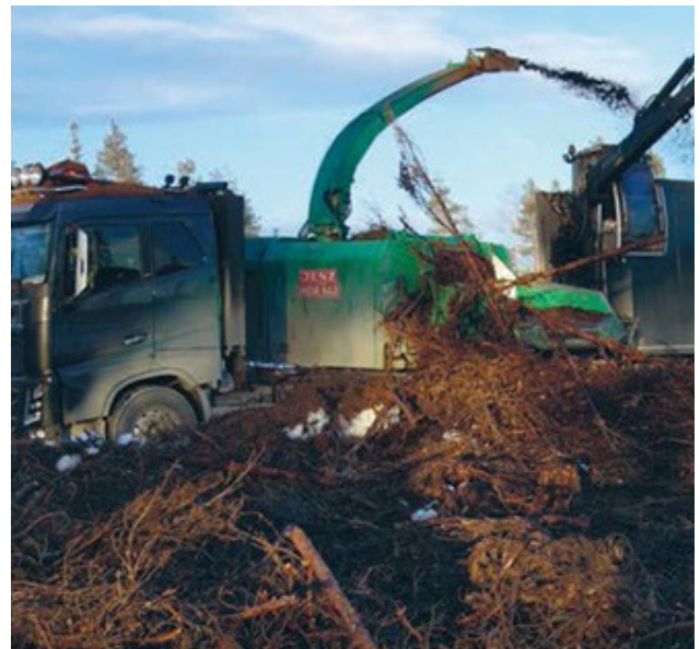
Flisning av grot vid bilväg. Här flisas groten med en så kallad lastbilshugg direkt i ett lastbilssläp.
